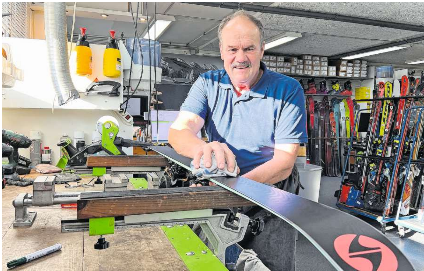
Markus Huser an der Werkbank im Skiservice-Center. Als letzte Handlung nach dem Schleifen wird der Ski poliert.
